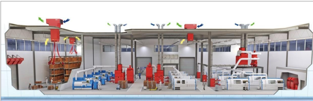
Abbildung Produktionshalle mit Hoval Systemlösung zur Hallenlüftung über Wärmerückgewinnung aus Prozessabluft.
